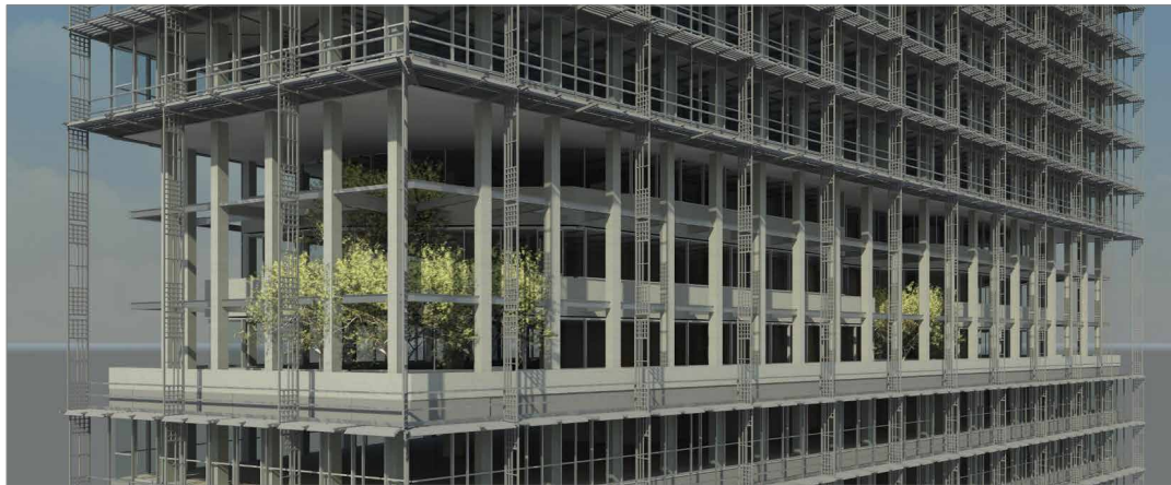
Maquette 3D (réalisée sur le logiciel REVIT) représentant les éléments structurels de la façade des étages atypiques
