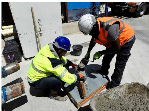
Essais d'ouvrabilité du béton (consistance du béton)
